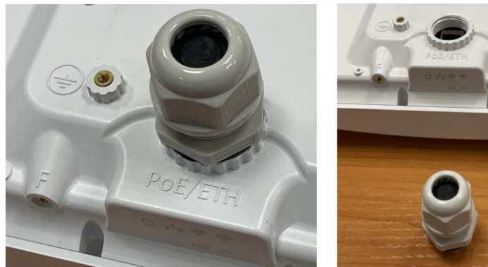
Рисунок 12 – Снятие кабельного ввода
