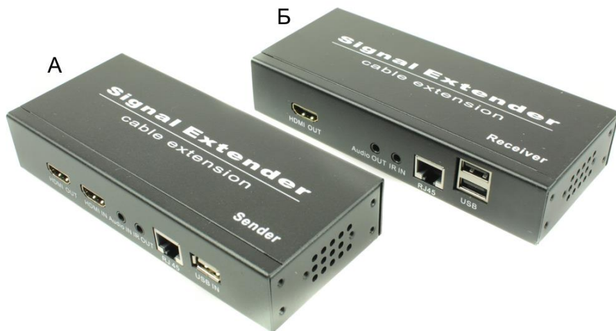
Рис.1 Комплект TLN-HiKM2+RLN-HiKM2, внешний вид (А – передатчик, Б – приемник)
